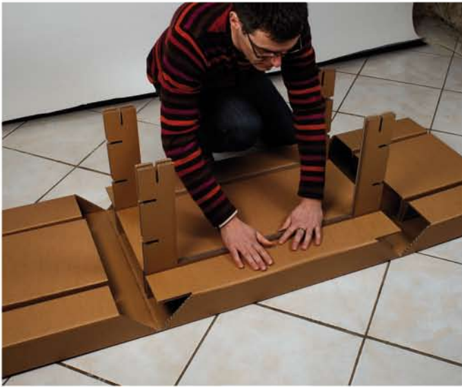
Positionnement des raidisseurs par le centre Ne pas forcer sur les côtés
